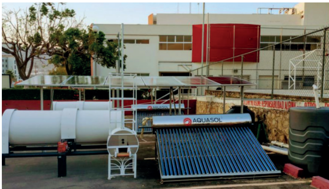
Figura 4. Prototipo de Secadores híbridos rotatorios para granos
